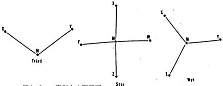
圖4:Loran發射台之配置圖
