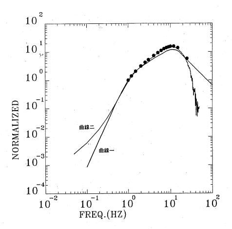
圖三、地震儀器響應曲線,圓點爲電流驅動方式 之反應値,曲線一爲其連線,25Hz以上之 反應曲線以外揷方式求得;曲線二爲重錘 釋放方式求得之曲線,較爲合理。
