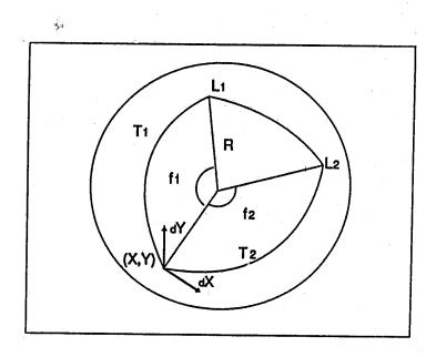
圖1:Loran-C站地球中心角之幾何圖示(摘自Vaisala, 1989)
