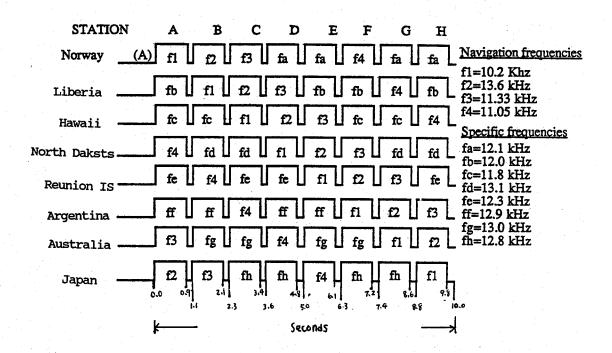
圖7: Omega信號發送型式 ( 摘自 Lange 1985 )
