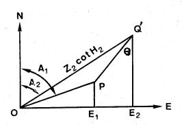
圖2: 單經緯儀測風風向量投影於N-E之平面 圖示法
