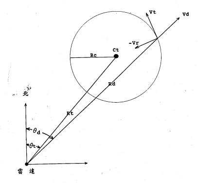
圖一、單都卜勒氣象雷達於座標(Rd,  $\theta$ d)處所偵測之徑向風速Vd與實際渦旋氣流幾何示意圖, 實際渦旋中心ct位於座標(Rt,  $\theta$ t),Vt正值爲氣旋式旋轉、Vr負值爲輻合、Vd負值示渦旋 氣流吹向雷達之風分量。
