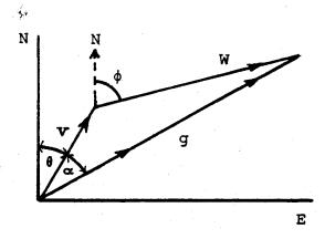
圖1:飛機測風之向量圖示
