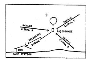
圖3:探空站接收氣球攜帶探空儀之無線電信 號圖示 (摘自Lange, 1985)
