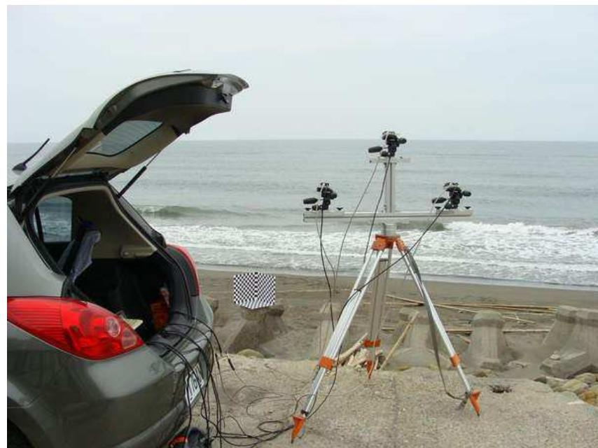
圖97 台南海岸現場測試作業情形(使用立體校正板)
