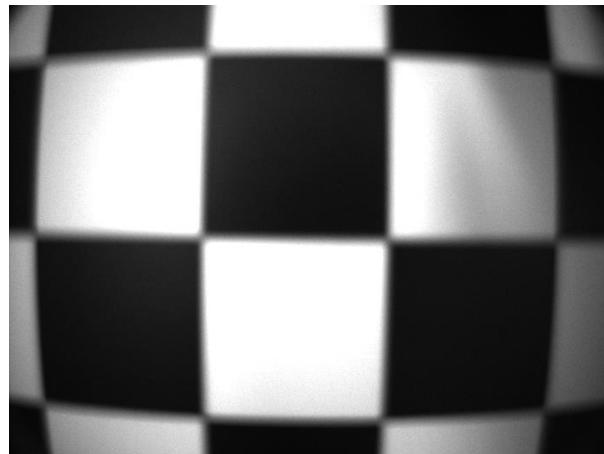
圖37 焦距6mm鏡頭拍攝之校正前影像
