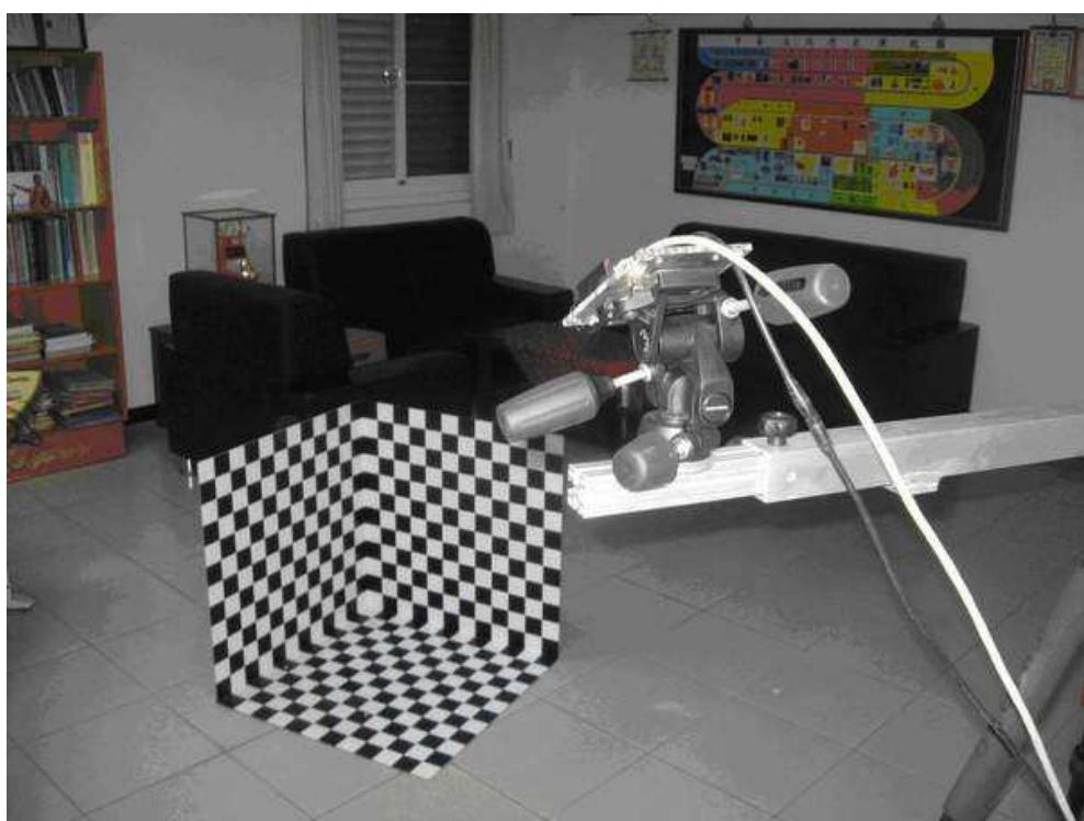
圖39 本計畫進行系統外部校正之過程
