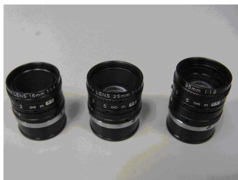
圖24 本計畫所使用之16、25、35mm 定焦距CCTV鏡頭
