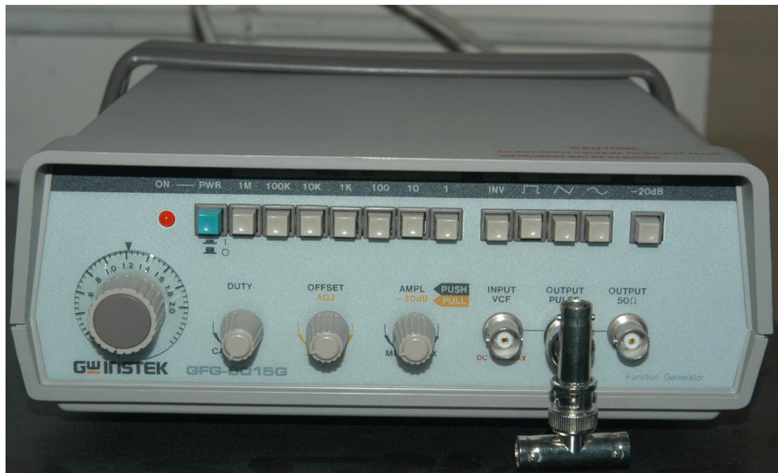
圖2-14 GW Instek之外部觸發器 (trigger)
