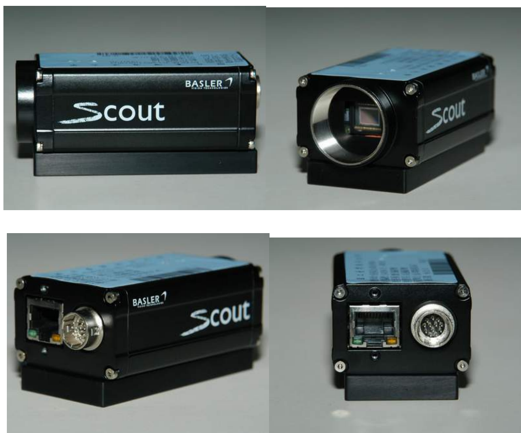
圖2-13 Basler scA1390-17gm高速攝影機外觀
