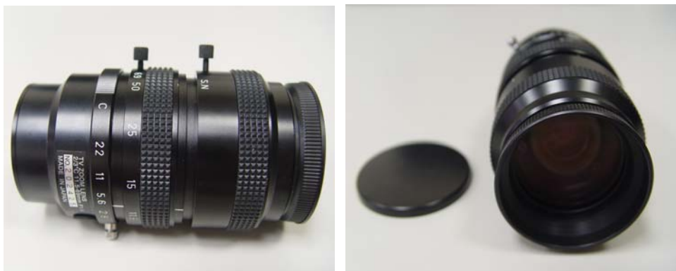
圖2-15 本計畫所使用之 11.5-69mm 可調焦距式CCTV鏡頭
