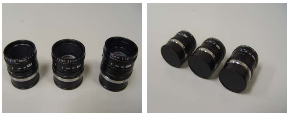
圖2-16 本計畫所使用之16、25、35mm 定焦距CCTV鏡頭
