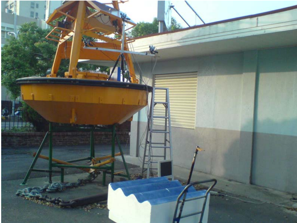
圖 6-2 實驗室人工推動波浪板模擬動態海況之試驗佈置
