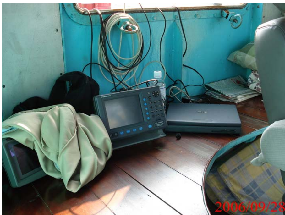
附圖3-9 漁探機及側掃聲納的顯示螢幕
