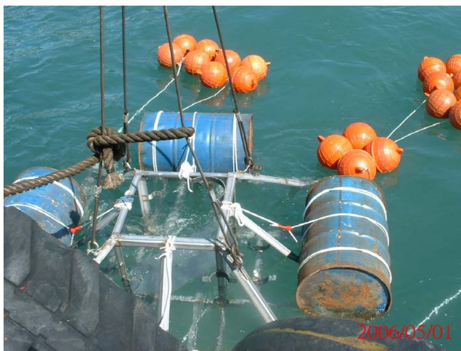
附圖3-2 海流儀固定座施放作業情況
