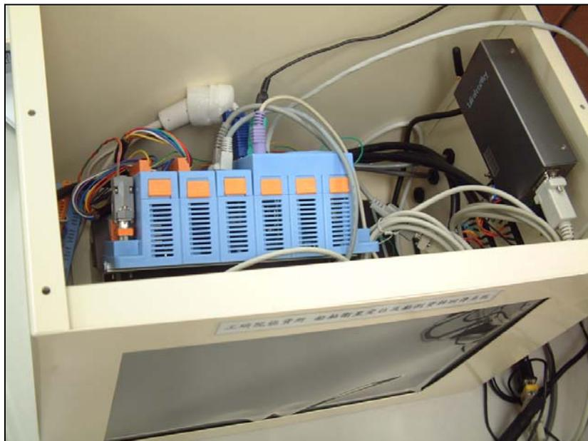
圖 6-17 船舶定位及資料回傳系統內部情形
