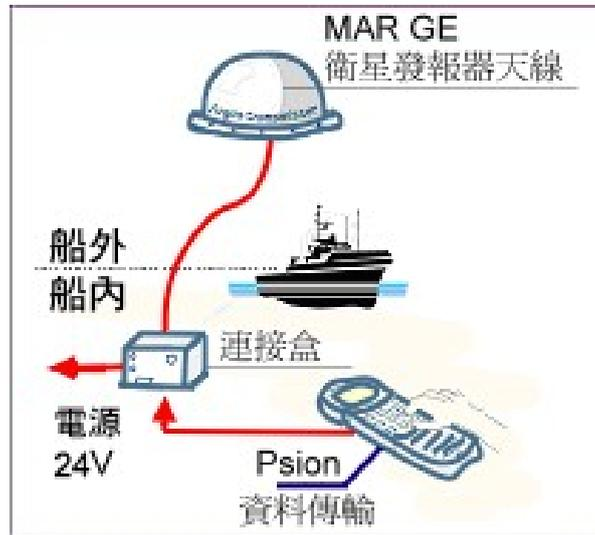
圖 6-2 ARGOS 漁船監控系統
