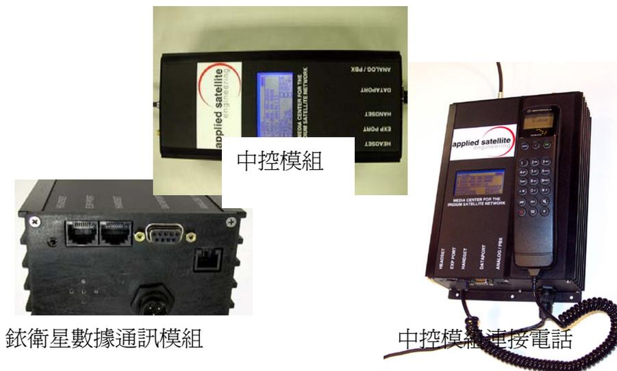
圖 6-4 衛星追蹤與語音/資料傳輸系統
