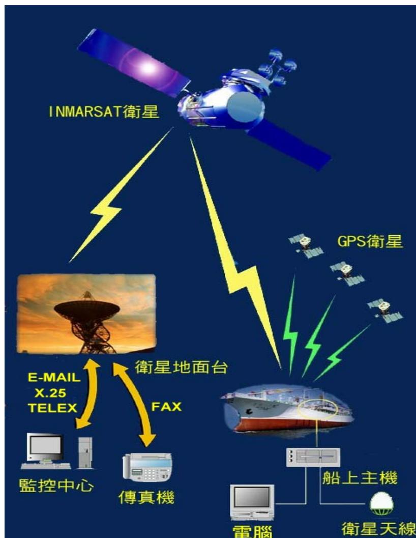
圖 6- 3 Inmarsat-C 漁船監控系統
