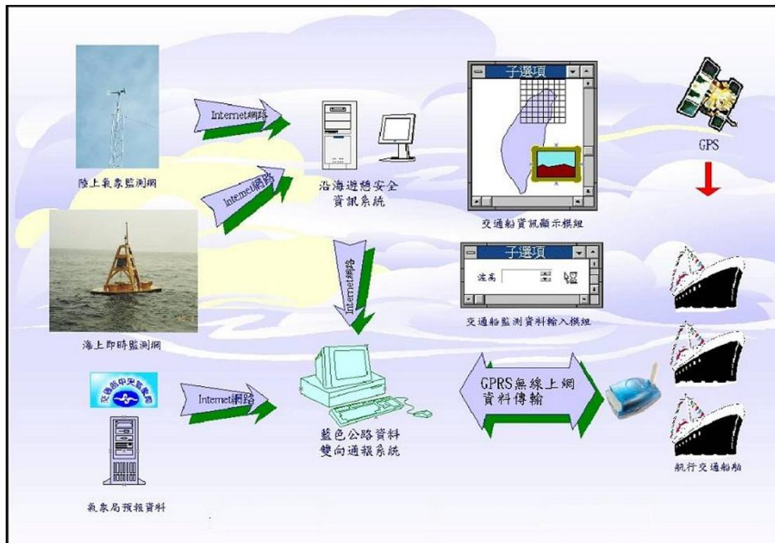
圖 6-1 近岸航船衛星追蹤網路地理資訊系統
