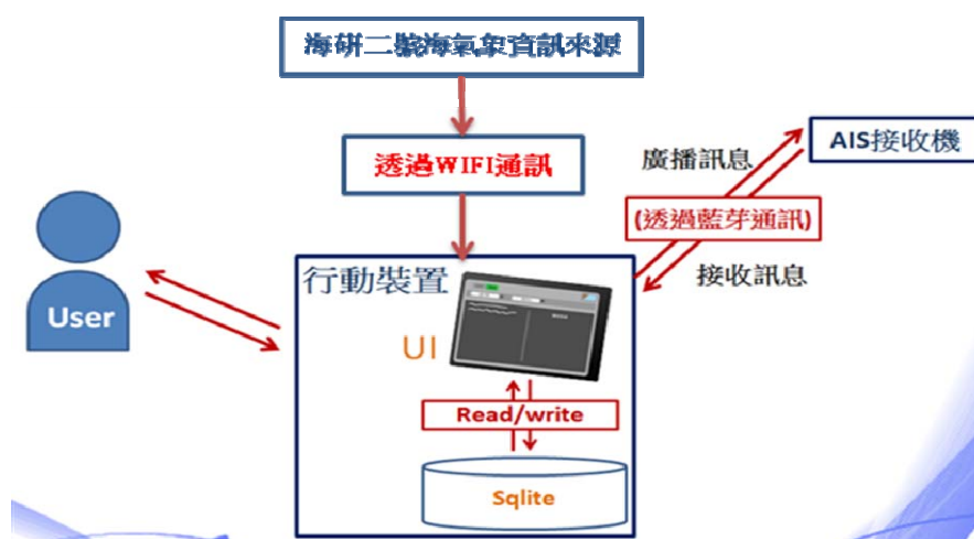
圖 6.1 系統架構與設備介接以海研二號為例
