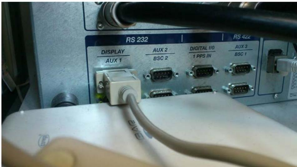
圖 6.3 岸台廣播軟體透過 RS232 接到 SAAB R40 AIS 基地的 DISPLAY 埠
