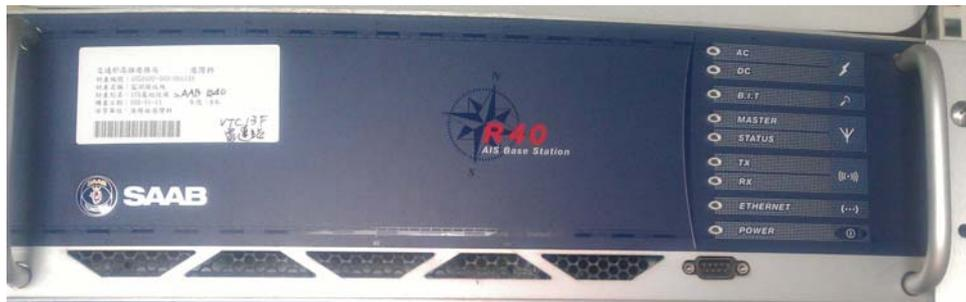
圖 6.1 SAAB R40 AIS 基站面板
