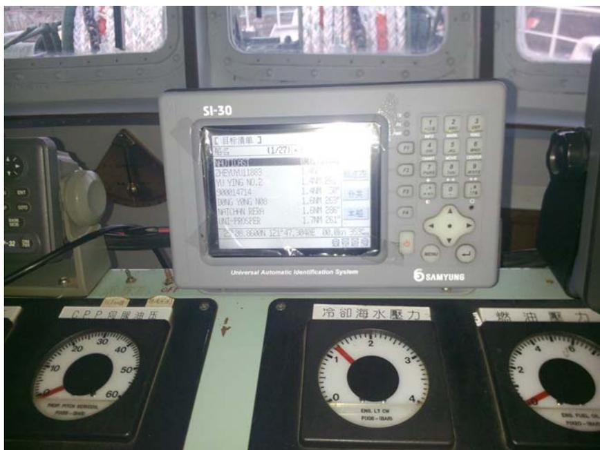
圖 5.9 海研二號駕駛台上的 Class A AIS 船台(正面)
