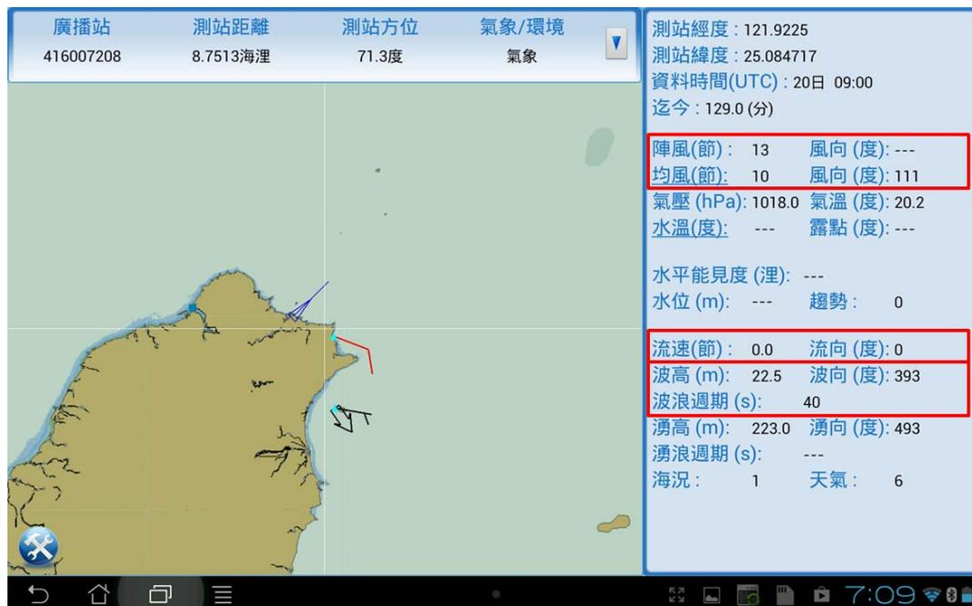
圖 5.2 船台顯示畫面之風速、風向，水流和浪高、浪向等資訊
