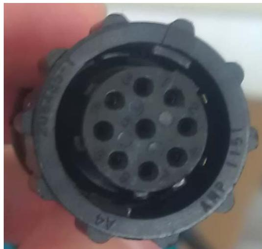
圖 5.12 AIS Pilot Plug 的接頭
