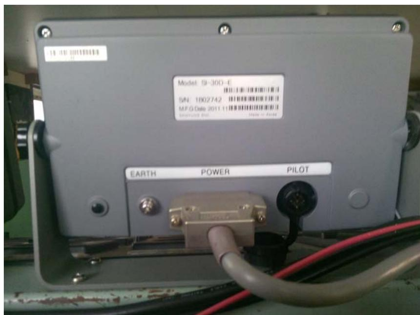
圖 5.10 AIS 設備(背面)以及要介接的 PILOT 孔
