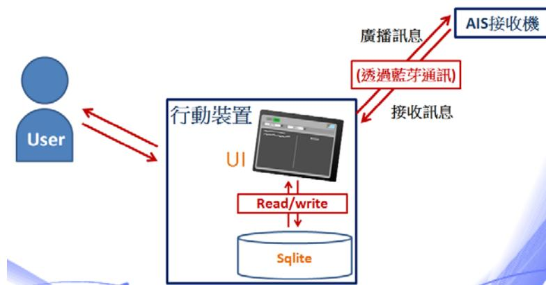
圖 5.1 船台應用軟體的運作架構示意圖
