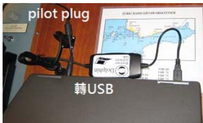
圖 3.9 芬蘭 VTT AIS+計畫的船上 AIS 設備介接情形
