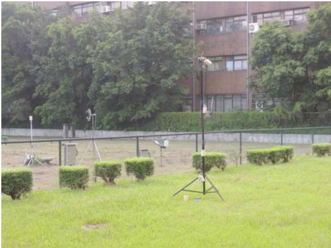
圖 18 5 套 EL-USB2 分別以離地 300cm、200cm、100cm、50cm、貼近地面等五高度懸掛成為垂直剖面量測平台。(上)臺灣大學大氣科學系地面氣象觀測坪 (下)臺灣大學大氣科學系 B 館大樓屋頂。(2016 年 6 月 22 日 3:00pm~6 月 23 日 3:00pm)
