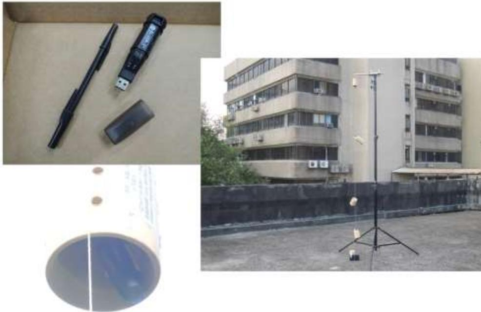
圖 5 英國 LASCAR 公司 EL-USB2 溫度濕度感測器和戶外垂直剖面量測(臺灣大學大氣科學系)。
