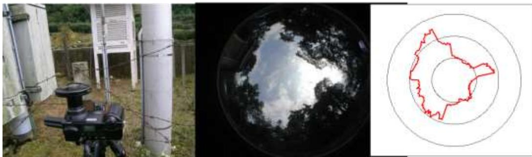
圖 3 (左)Nikon Coolpix-800 數位相機、Nikon FC-E8 魚眼鏡頭、相機腳架和水平儀，(中)拍攝觀測地點全天空彩色影像，(右)再經由影像軟體轉換成「天空為白色，遮蔽物為黑色」之黑白圖樣。
