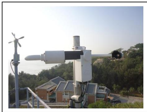
圖 2.2: (A)基隆 (B)台北 (C)日月潭 (D)嘉義(E) 高雄 (F)金門測站之能見度儀現場與外觀。
