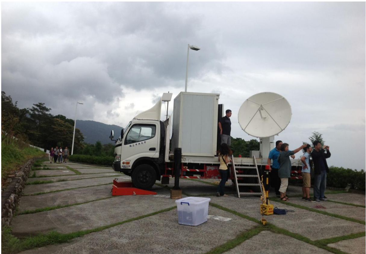
圖 9：2012 年杰拉華颱風期間與颱洪中心共同測試位於佛光大學的雷達車永久地樁性能。
