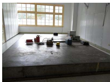
圖 6. 現存地震儀室與置放儀器平台
