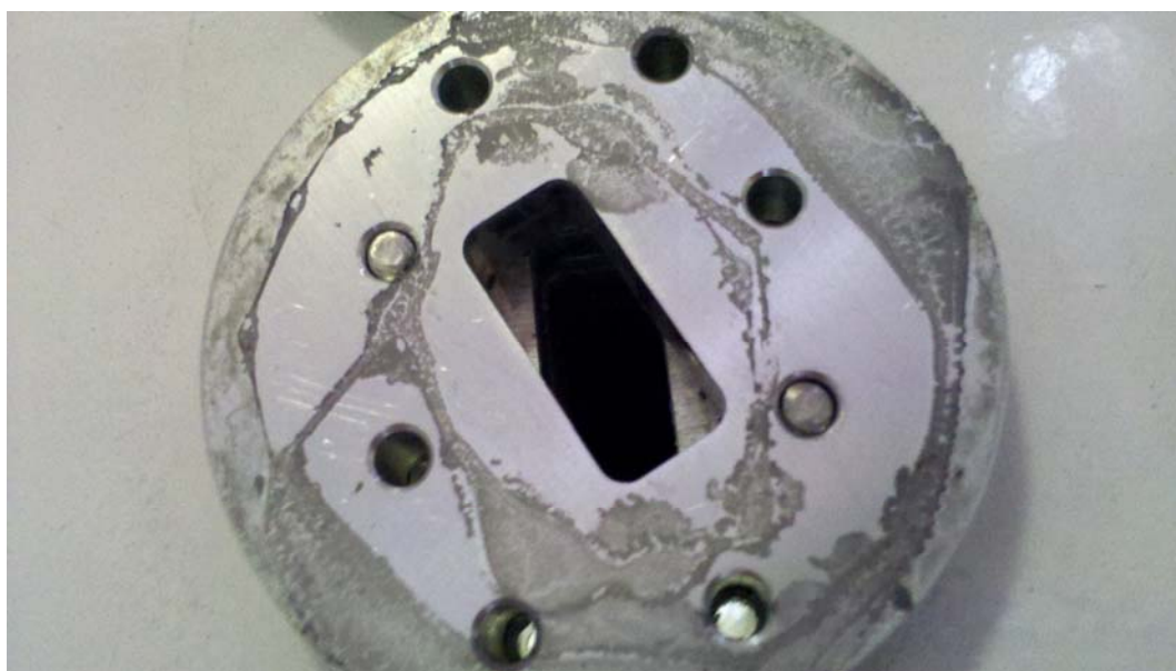
圖 22：原導波管轉向方式，以直接在轉接盤面作無過渡性轉向。
