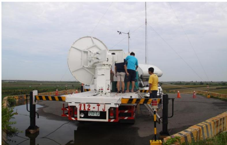
圖 5：圍潭堤防觀測現場，進行每日儀器例行檢查及發電機加油工作。
