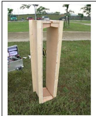
圖 20: 2005 年 6 月 17 日 Jack 1.0 短場彈射起飛架構、實際測試以及木架摺疊。
