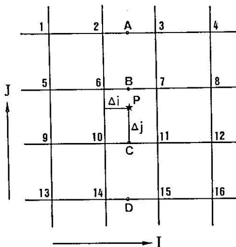
圖5：16點Bessel內插網格點分佈，P點代表欲內插之直角座標網格點。
