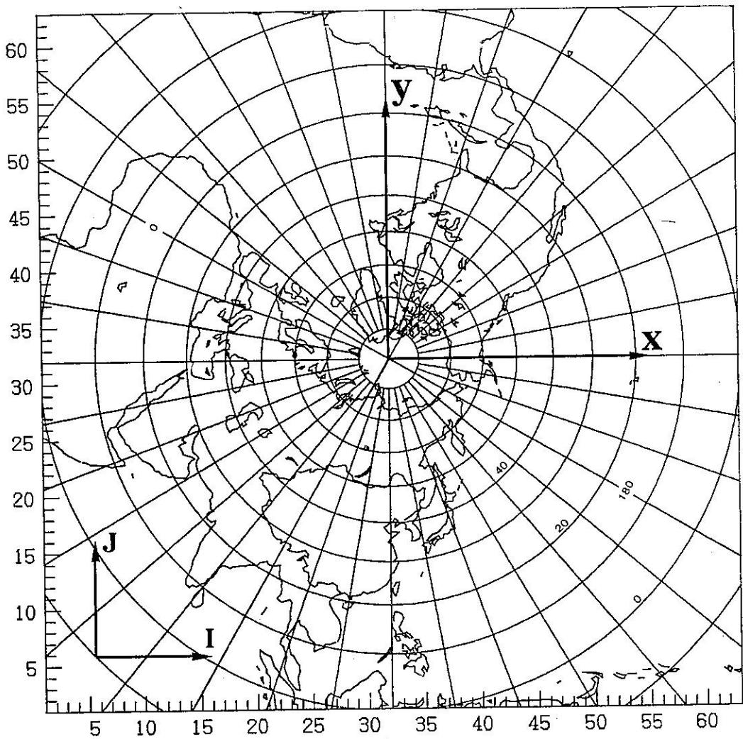
圖 1：北半球極方位投影直角座標(x,y)及網格系統(I,J)。
