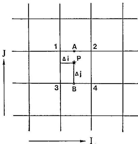
圖4：4點線性內插網格點分佈，P點代表欲內插之直角座標網格點。
