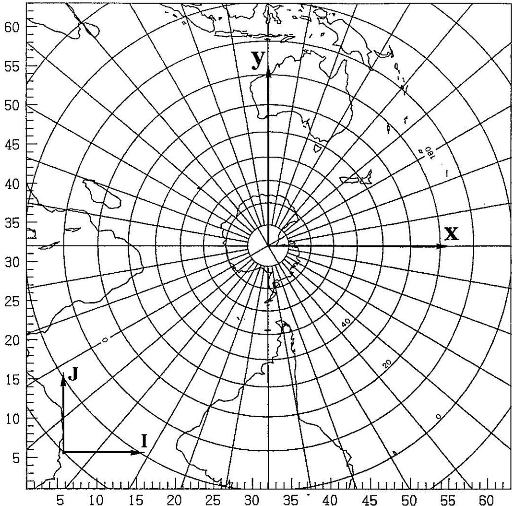
圖2：南半球極方位投影直角座標(x,y)及網格系統(I,J)。
