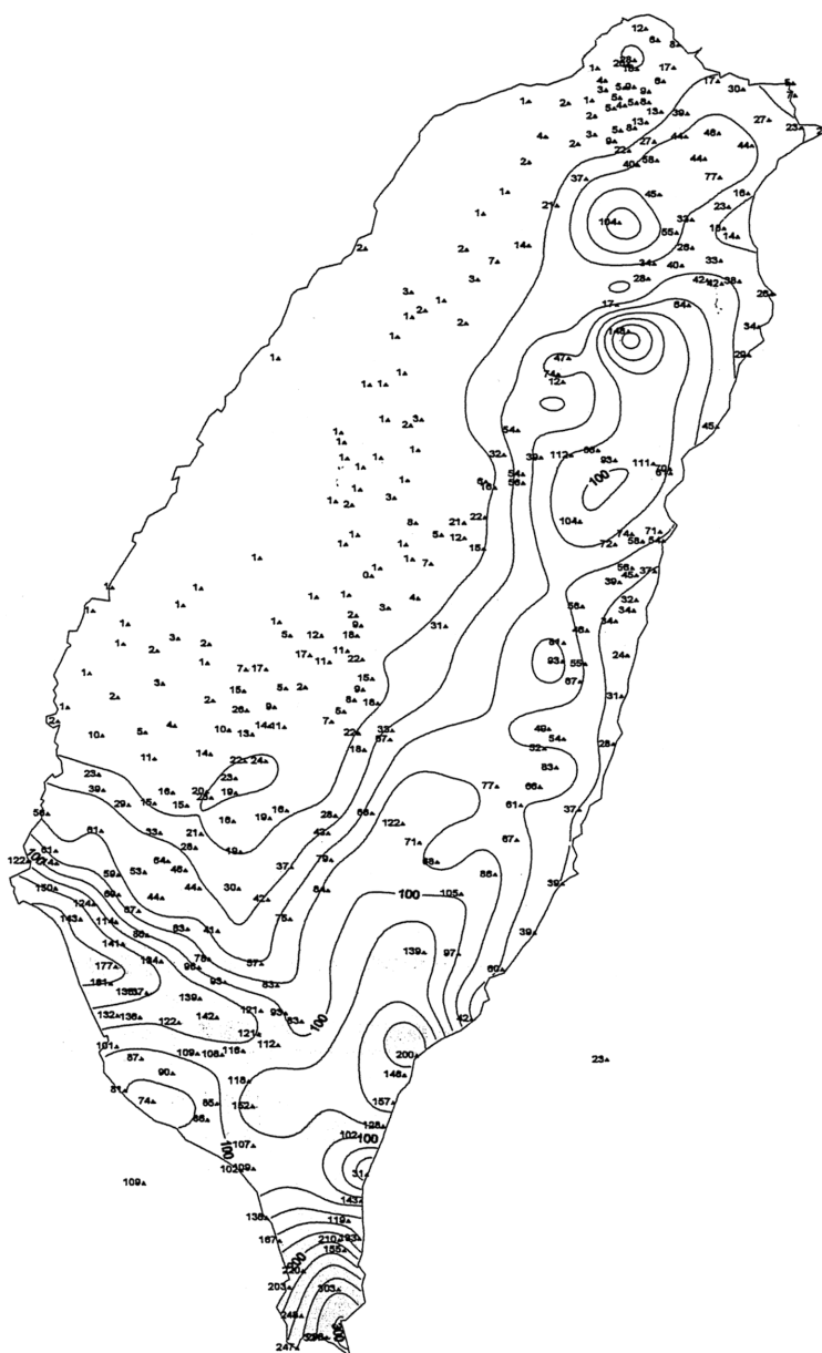
圖 9. 2007 年第 7 號(梧提)颱風侵台期間(8 月 08 日~09 日)台灣地區等雨量線圖
